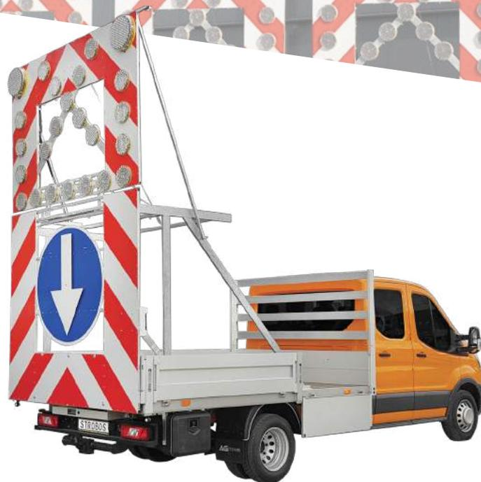
**Verkehrssicherungsanhänger U26A auf einem Fahrzeug montiert**
